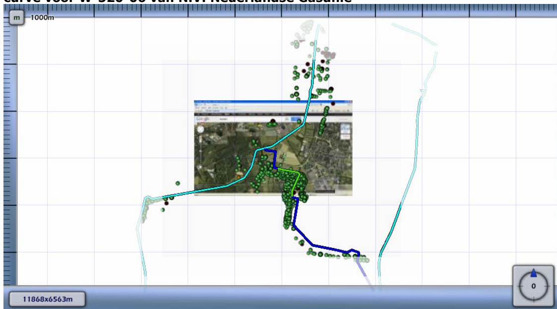
Figuur 4.4 Kilometer leiding behorende bij de maximale overschrijding van de FN-curve voor W-520-06 van N.V. Nederlandse Gasunie
