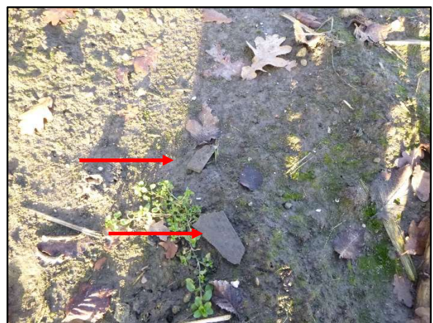
Foto 12: Asbestverdachte materialen op maaiveld ST2
