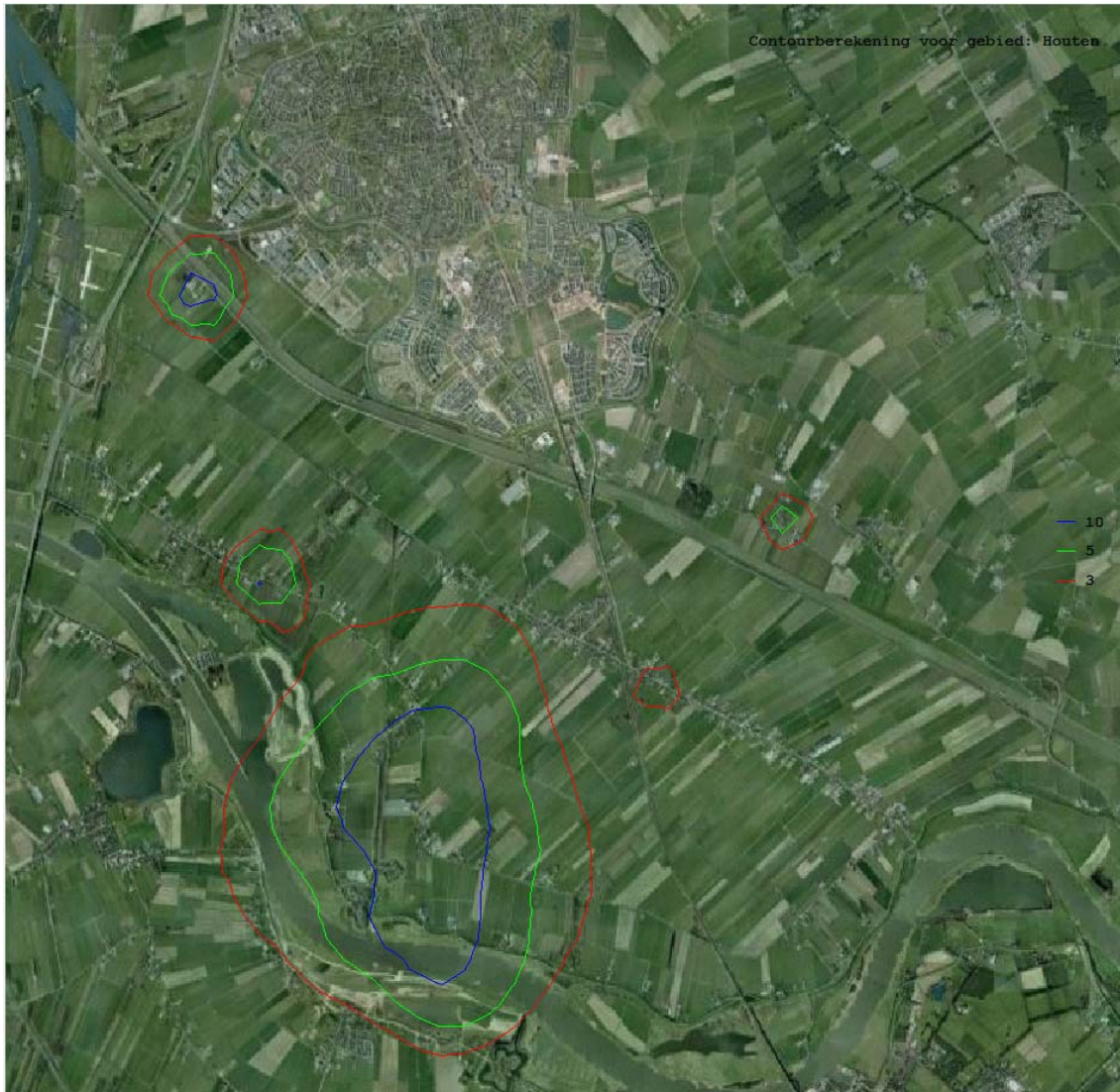
Figuur 6.2 Geurcontouren maximale invulling (blauw = 8 ouE/m 3 , groen is 5 ouE/m 3 en rood is 2 ouE/m 3 )
