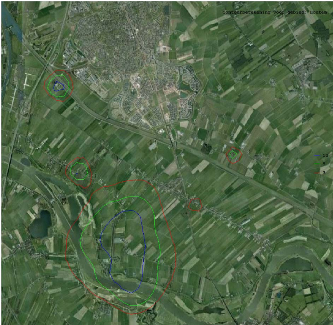
Figuur 6.2 Geurcontouren maximale invulling (blauw = 8 ouE/m 3 , groen is 5 ouE/m 3 en rood is 2 ouE/m 3 )
