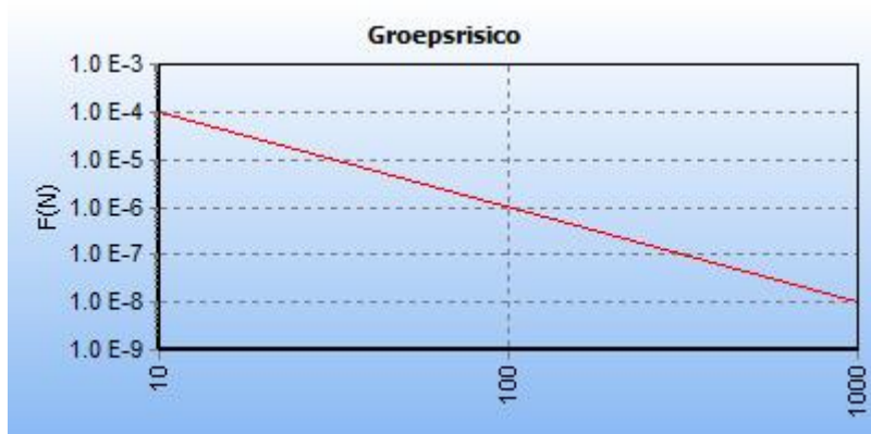
5.1 Figuur 5.1 FN curve voor 3249_leiding-W-500-05-deel-1_incl verl van N.V. Nederlandse Gasunie voor de kilometer tussen stationing 640.00 en stationing 1640.00
