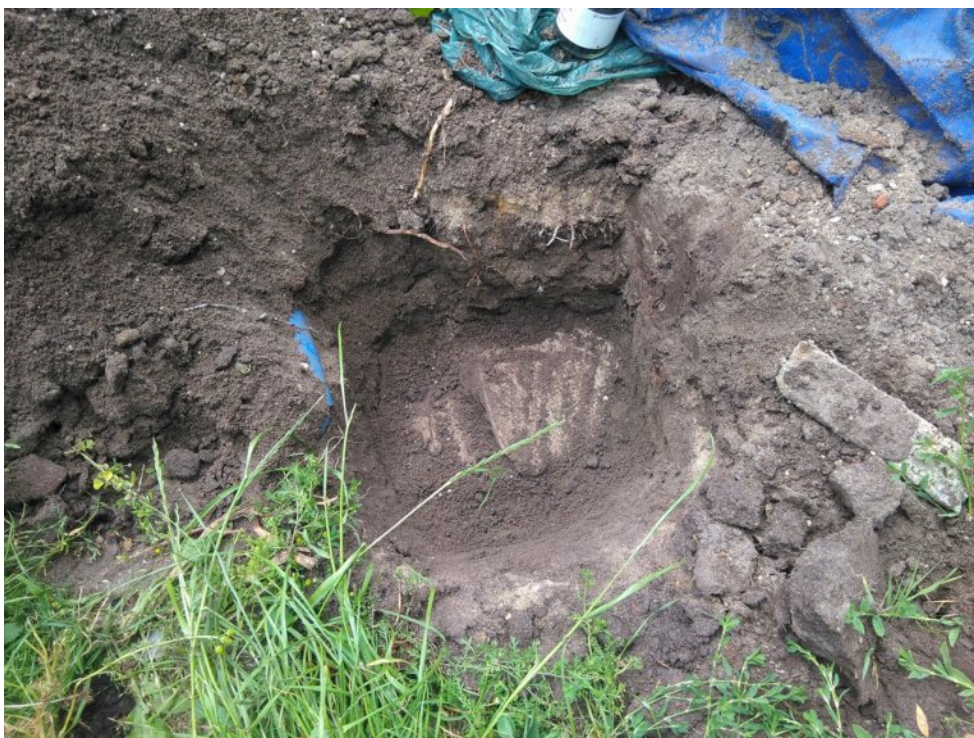
Foto 8: asbestplaat in gat G10
