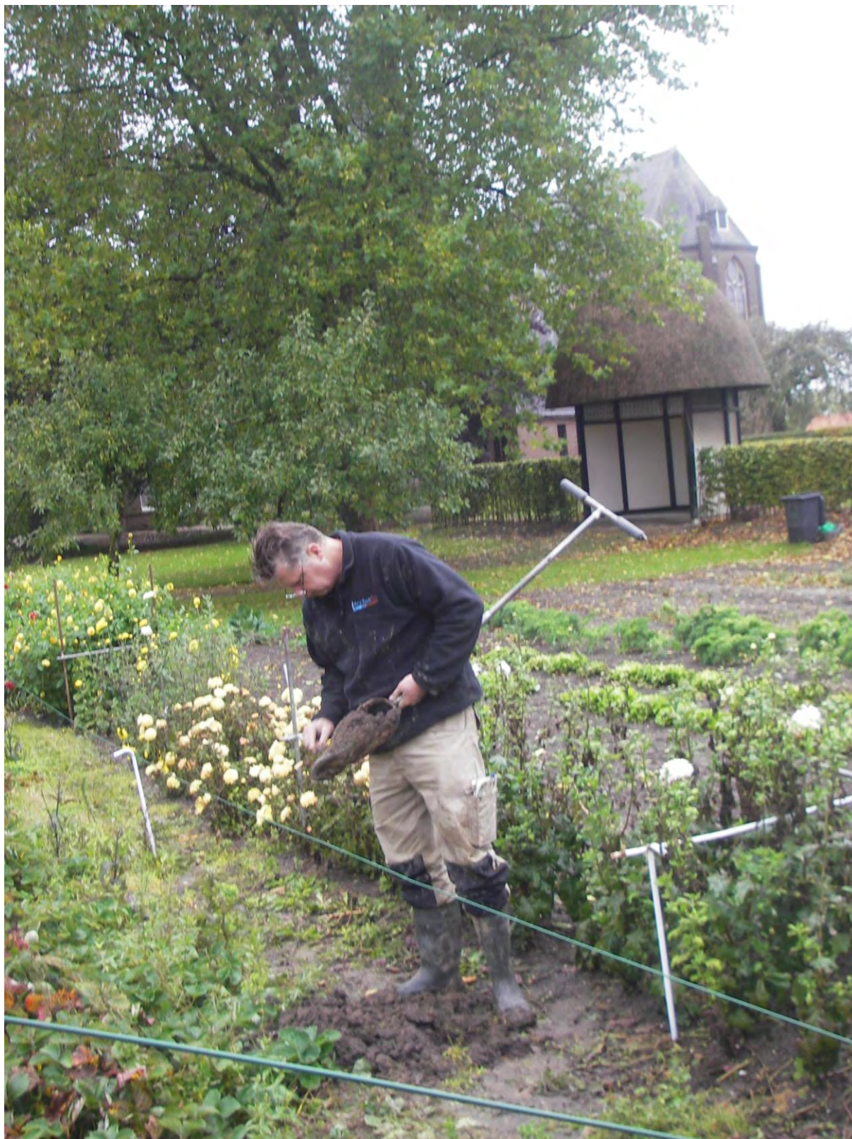
Figuur 16: Het boren binnen het plangebied met de edelmanboor met een diameter van twaalf centimeter.
