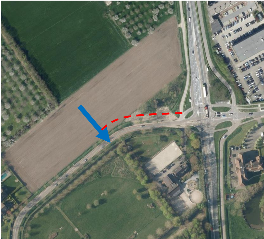
Figuur 8: voorstel vrijliggend fietspad langs N410
