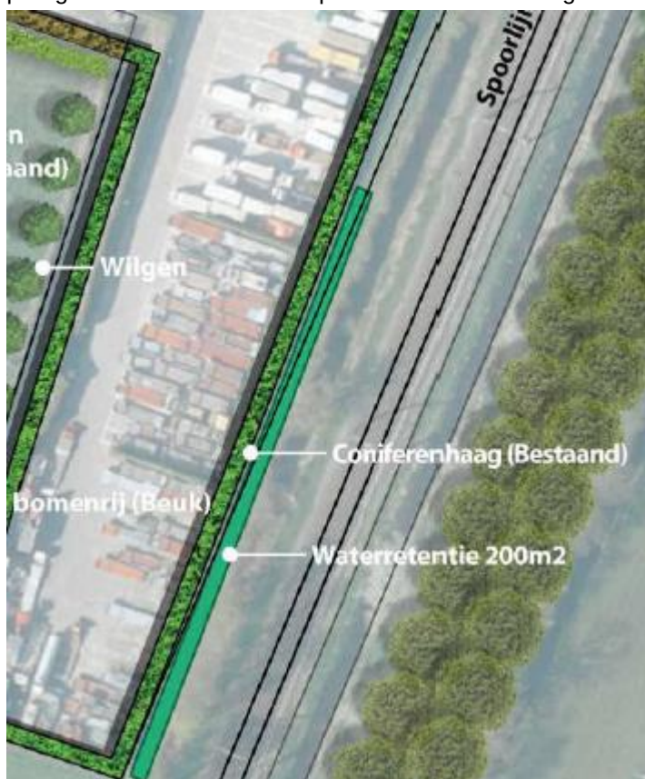
Indicatieve situering infiltratie- en bergingsvoorziening
