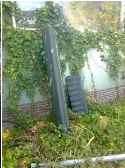
Foto 4.4: Asbestverdacht materiaal in groenstrook aan noordoostzijde locatie
