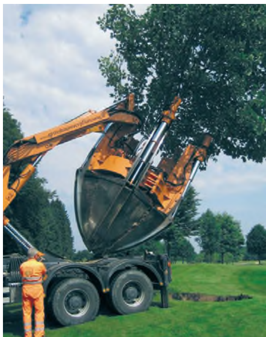
Afb. 4. Verplantschep Optimal (voor kluit van 190 tot 300 cm doorsnede).
