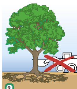
9 Rijd nooit met zwaar materiaal over de wortelkluif. Dit leidt tot verdichting en verstikking van de bodem met wortelstorte als gevolg. Is dit onvermijdelijk, plaats dan sloopshulden op een bed van grof zand.
