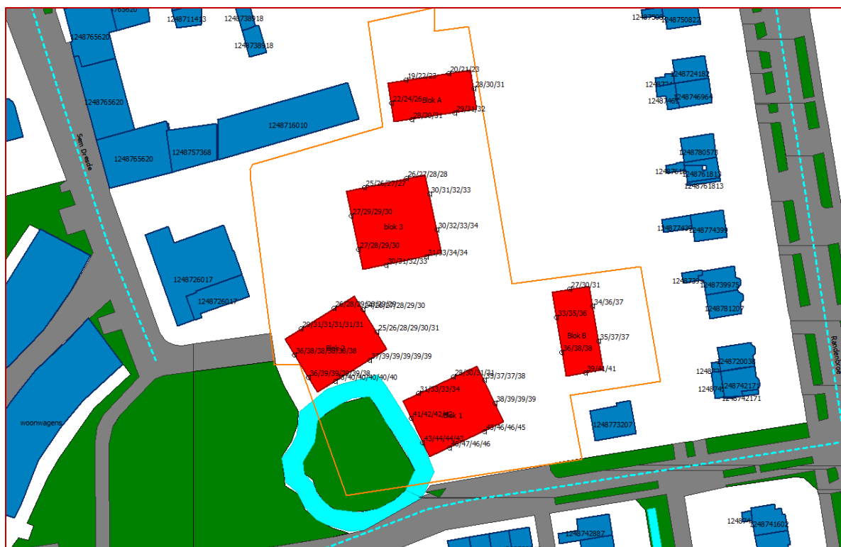
Figuur 4.3: Rekenresultaten vanwege alle 30 km/u wegen nabij de planlocatie, met 5 dB aftrek.
