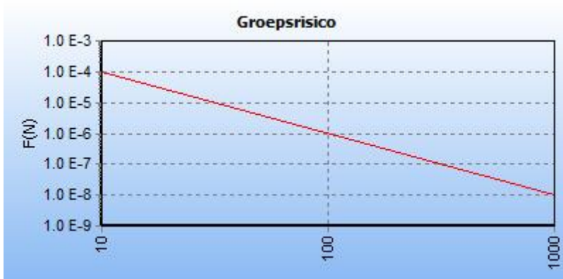
5.2 Figuur 5.2 FN curve voor 3493_leiding-W-500-01-deel-1 van N.V. Nederlandse Gasunie voor de kilometer tussen stationing 0.00 en stationing 1000.00
