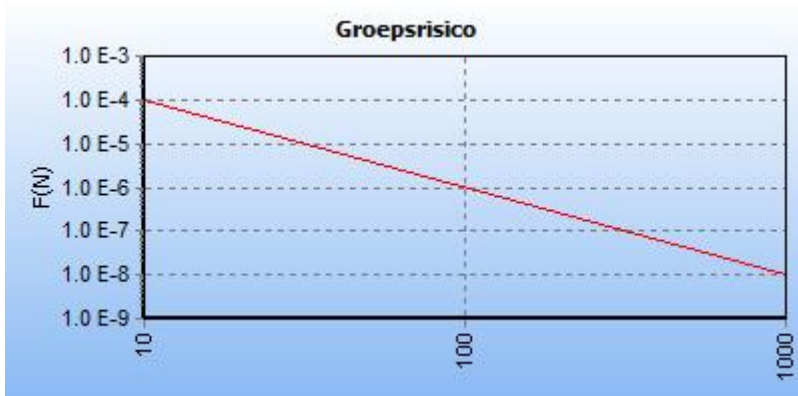
5.2 Figuur 5.2 FN curve voor 3493_leiding-W-500-01-deel-1 van N.V. Nederlandse Gasunie voor de kilometer tussen stationing 0.00 en stationing 1000.00
