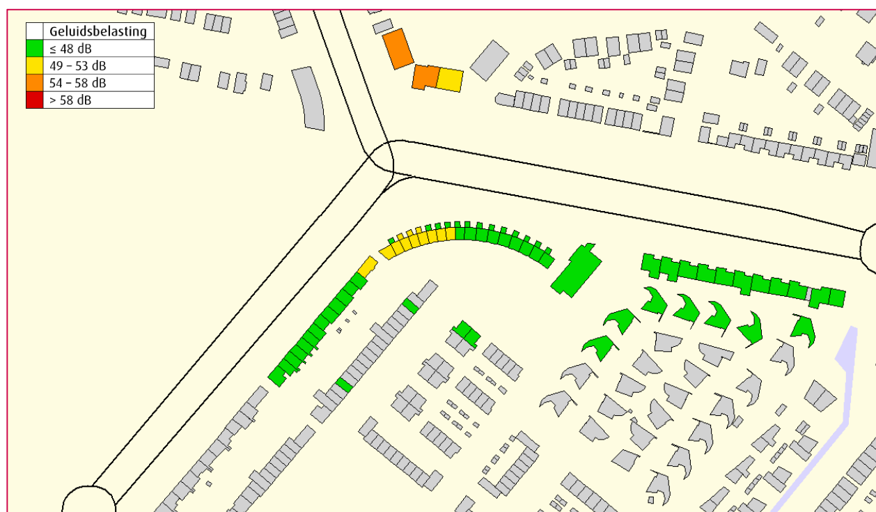
Figuur 4.3: Geluidsbelasting bestaande/geprojecteerde woningen t.g.v. Stadslaan (incl. correctie art. 110g Wgh.)
