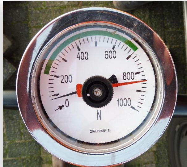
Foto 11: bodemverdichting lokaal ruim 8 MPa
