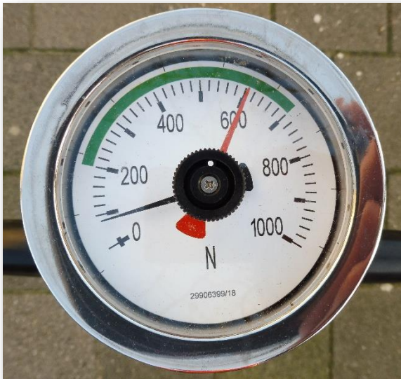
Foto 10: gemiddelde bodemverdichting 6 MPa
