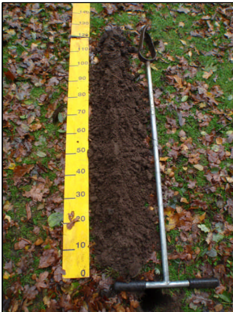
Resultaat van een profielboring.
