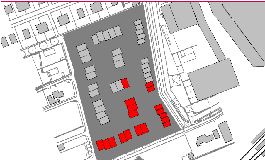
Figuur 4.1: Woningen met een overschrijding (rood) van de voorkeursgrenswaarde ten gevolge van het railverkeer
