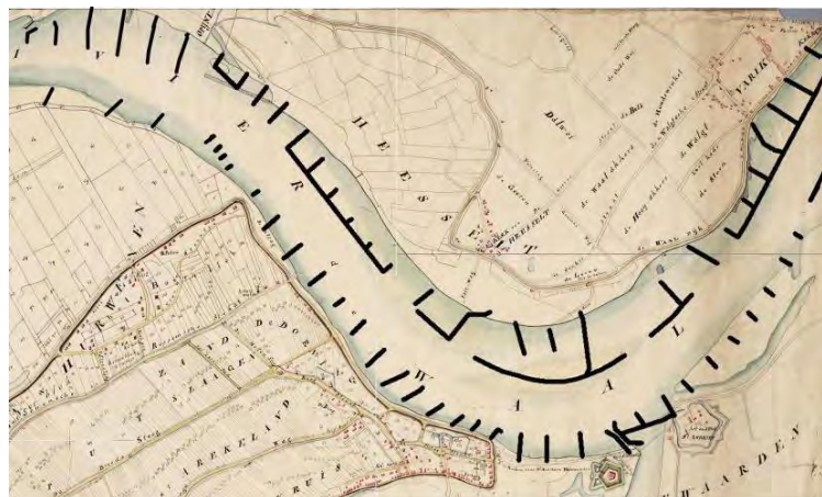
figuur 10. De riviernormalisatie rond 1875 legde de rivier aan banden en zorgde voor een grote verandering van de oevers. De aangelegde dammen zijn hier ingetekend op de kaart van 1825.
