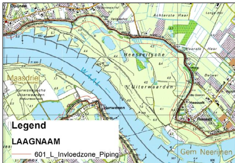
Figuur 5.9 Invloedzone piping [Waterschap Rivierenland, 2010]
