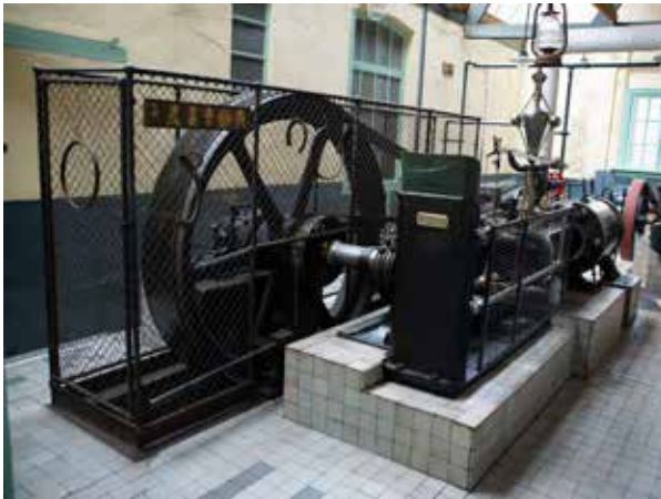
41, 42. Het "hart" van de zagerij: de stoommachine van de gebroeders Meer uit Mönchen Gladbach (1897). Het vliegwiel hangt in een gemetselde bak.
