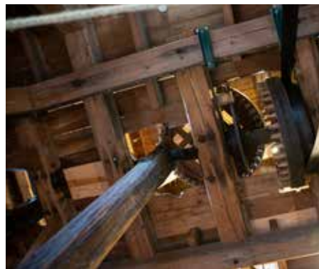
24, 25. Aan de onderkant van de korte koningsspil bevindt zich de onderbonkelaar. Dit horizontale tandrad zet het krukwieltje (een verticaal rad) in beweging. Het krukwieltje is bevestigd op de krukas (zie afbeelding 18) die er voor zorgt dat de wuifelaar op en neer gaat.
