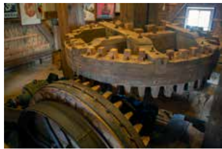
24, 25. Aan de onderkant van de korte koningsspil bevindt zich de onderbonkelaar. Dit horizontale tandrad zet het krukwieltje (een verticaal rad) in beweging. Het krukwieltje is bevestigd op de krukas (zie afbeelding 18) die er voor zorgt dat de wuifelaar op en neer gaat.
