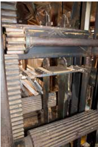
43, 44. Verticaal zaagraam en zaagslede bij Nahuys..
