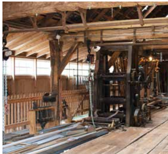
41, 42. Het "hart" van de zagerij: de stoommachine van de gebroeders Meer uit Mönchen Gladbach (1897). Het vliegwiel hangt in een gemetselde bak.
