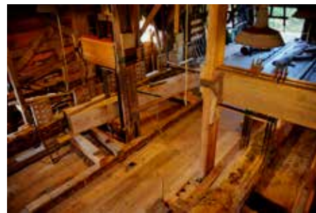
26-28. Linksboven de wuifelaar die via de krukas zorgt voor een op en neer gaande beweging van het zaagraam (rechts). Een viertal zagen zaagt de stam die met het krabbelwerk langzaam over de zaagslede wordt getrokken.
