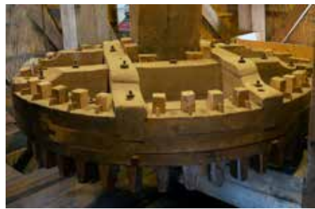
24, 25. Aan de onderkant van de korte koningsspil bevindt zich de onderbonkelaar. Dit horizontale tandrad zet het krukwieltje (een verticaal rad) in beweging. Het krukwieltje is bevestigd op de krukas (zie afbeelding 18) die er voor zorgt dat de wuifelaar op en neer gaat.
