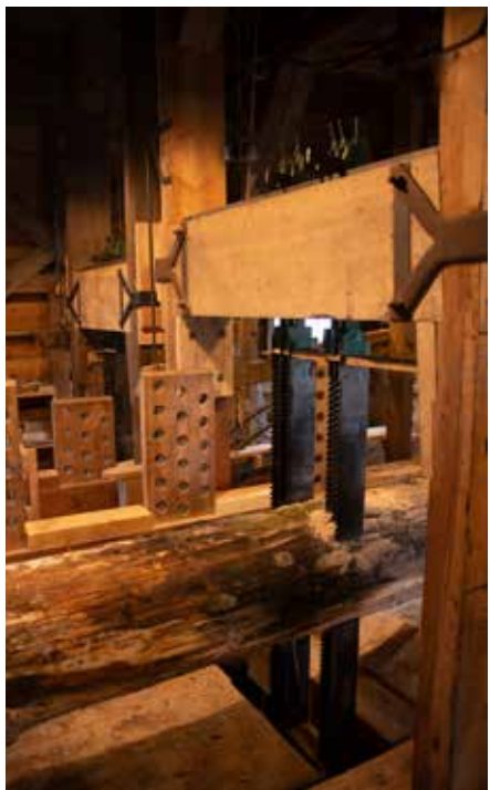
26-28. Linksboven de wuifelaar die via de krukas zorgt voor een op en neer gaande beweging van het zaagraam (rechts). Een viertal zagen zaagt de stam die met het krabbelwerk langzaam over de zaagslede wordt getrokken.
