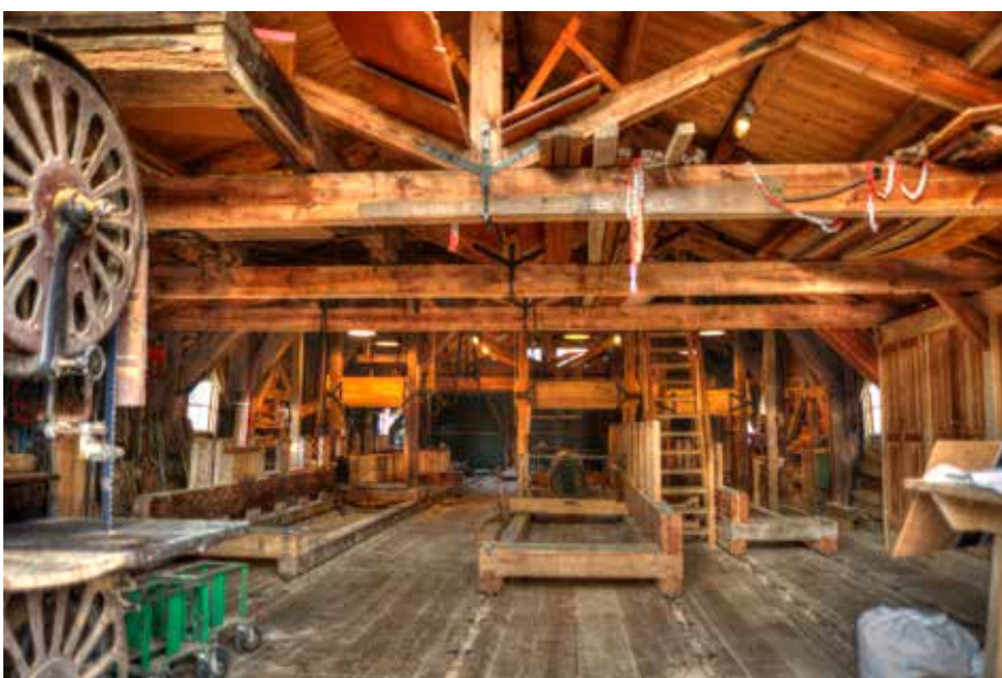
21. De zaagschuur van de Bolwerksmolen met in het midden de zaagslee. Aan de balk vooraan hangt een lange kraanzaag (vgl. afb. 13).
