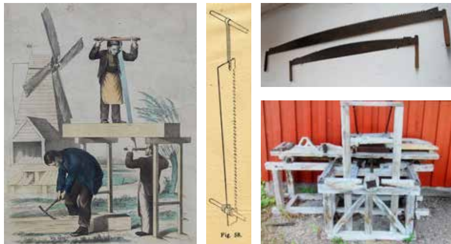
12-15. Links een laat 19 e -eeuwse schoolplaat die het gebruik van de kraanzaag toont en tevens het disselen van een balk. Daarnaast een afbeelding van een dergelijke zaag voor het lengte-zagen van balken. Rechtsboven kort- of trekzagen voor het afkorten van balken (collectie Nahuys) en een hand-cirkelzaag (Sandvika, Nord-Trøndelag, Noorwegen).
