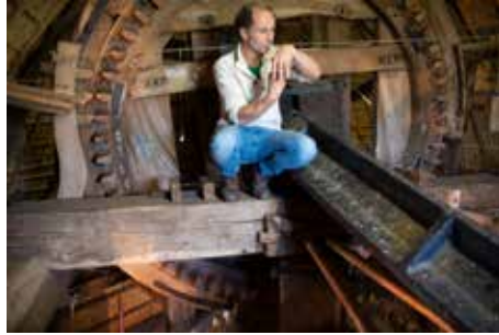
22, 23. Anatomie van de Bolwerkmolen van boven naar beneden. Links molenaar Rob Schutte in de kap, waar de ijzeren as met het bovenwiel loopt die door het wiekenkruis in beweging wordt gezet. Rechts: het verticaal geplaatste bovenwiel zet via de bovenbonkelaar (horizontaal tandwiel) de koningsspil in beweging.
