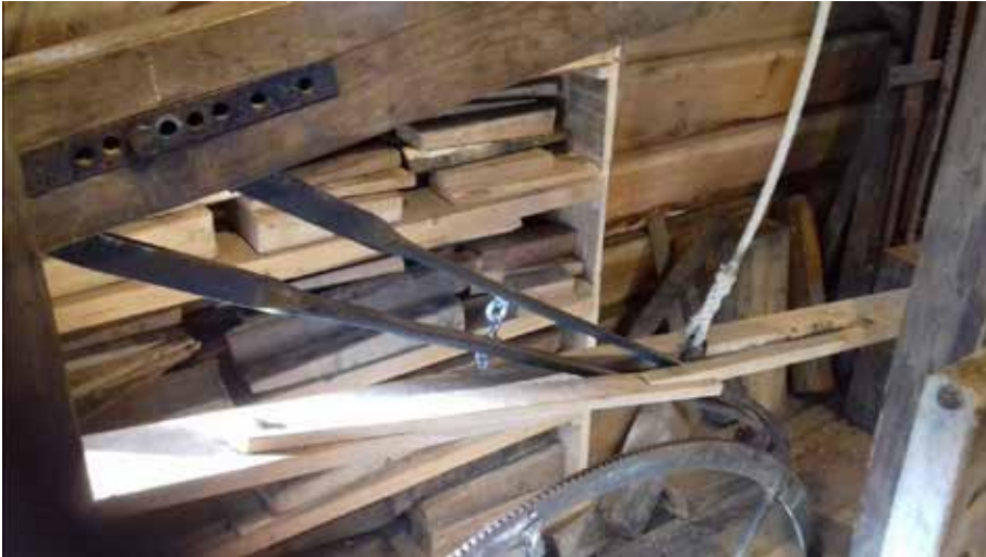
29-31. De zagen worden in het spanhoofd op spanning gezet met behulp van ijzeren wiggen, die er met een hamer in worden geslagen. Daaronder het krabbelwerk.
