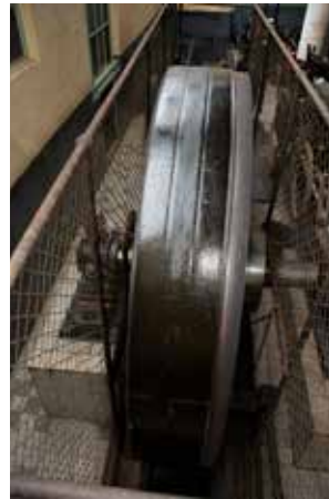
41, 42. Het "hart" van de zagerij: de stoommachine van de gebroeders Meer uit Mönchen Gladbach (1897). Het vliegwiel hangt in een gemetselde bak.
