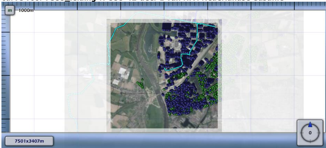
Figuur 4.3 Kilometer leiding behorende bij de maximale overschrijding van de FN-curve voor 7355_leiding-N-558-42-deel-1 van N.V. Nederlandse Gasunie
