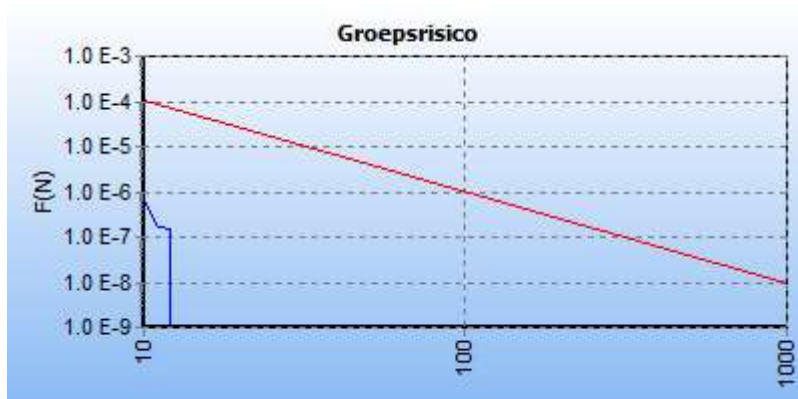
5.7 Figuur 5.7 FN curve voor A-506 van N.V. Nederlandse Gasunie voor de kilometer tussen stationing 43920.00 en stationing 44920.00
