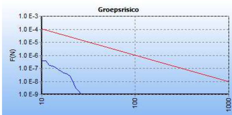
5.7 Figuur 5.7 FN curve voor A-506 van N.V. Nederlandse Gasunie voor de kilometer tussen stationing 43920.00 en stationing 44920.00
