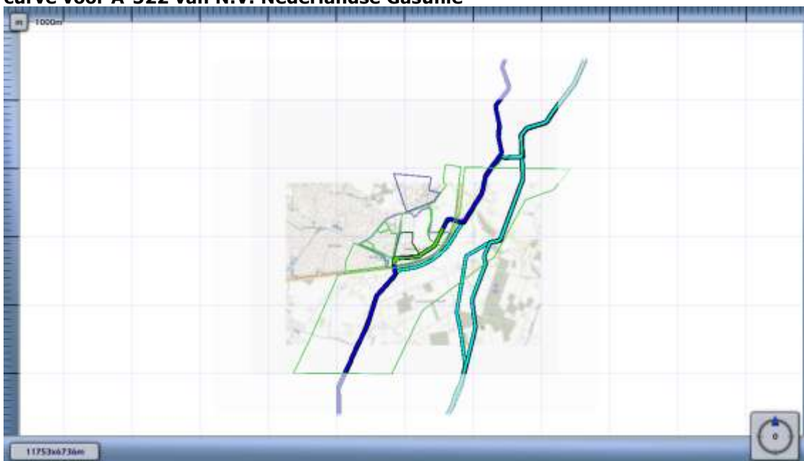
Figuur 4.2 Kilometer leiding behorende bij de maximale overschrijding van de FN-curve voor A-522 van N.V. Nederlandse Gasunie
