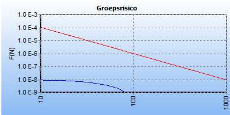
5.3 Figuur 5.3 FN curve voor A-662 van N.V. Nederlandse Gasunie voor de kilometer tussen stationing 45810.00 en stationing 46810.00
