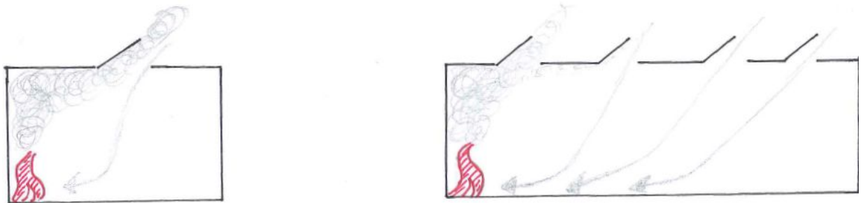
Figuur 2. Luchtstroming bij 1 of meerdere rookluiken.
