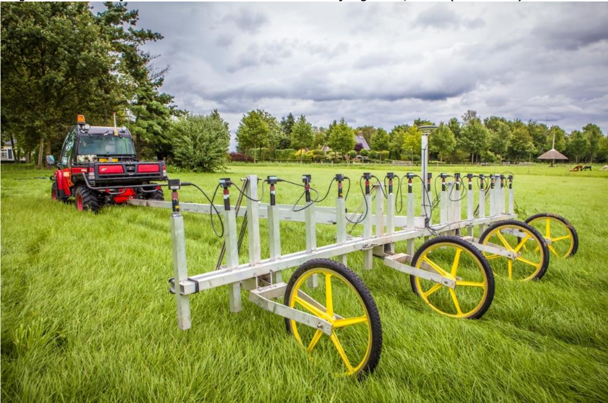
Figuur 3: Detectievoertuig zoals deze gebruikt is voor het uitvoeren van de passieve non-realtime oppervlakedetectie.
