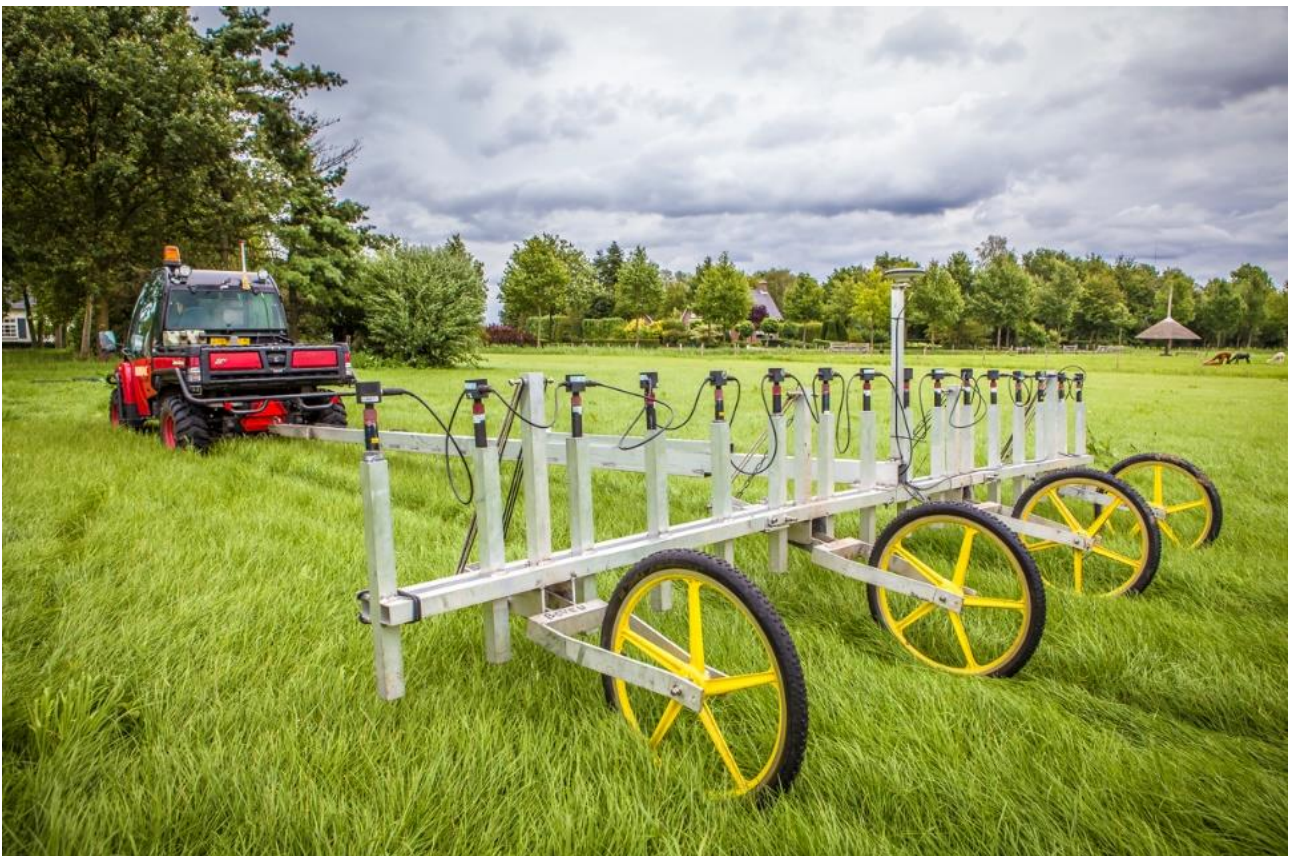
Figuur 2: Detectievoertuig zoals deze gebruikt is voor het uitvoeren van de computerondersteunde digitale oppervlakedetectie.
