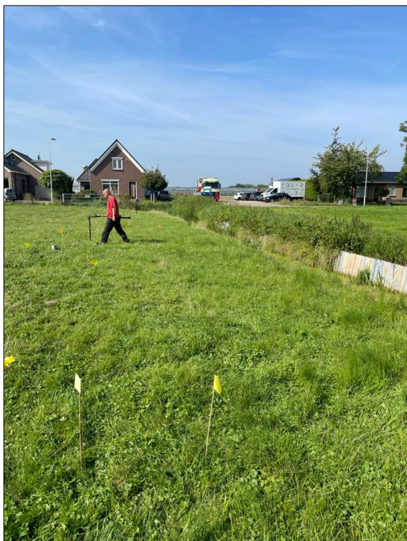
Figuur 5. Uitvoeren passieve realtime detectie en verstorende damwand in de watergang.
