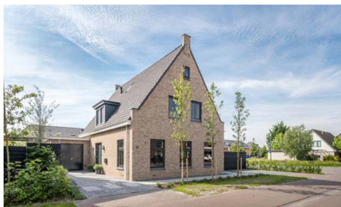
Fig. 4.6 Topgavel met dwarskap
