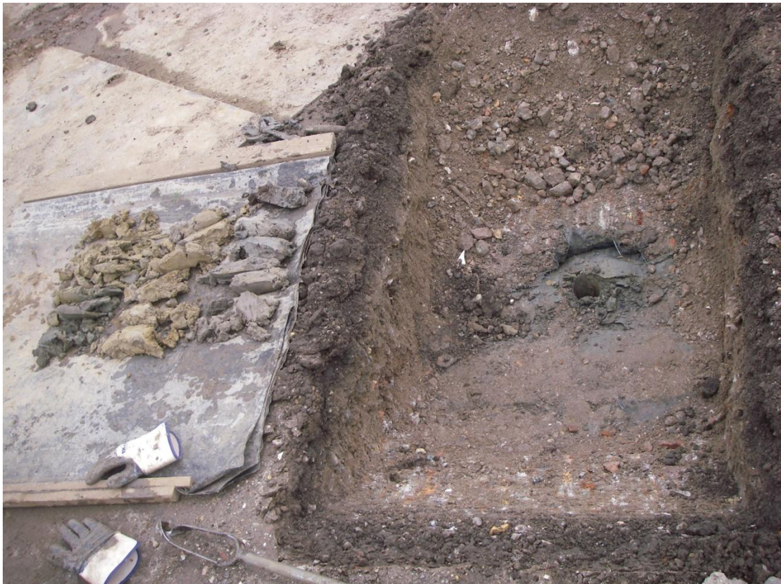
Fig. 3.1: Puinverharding met boorgat ter plaatse van boring 3.
