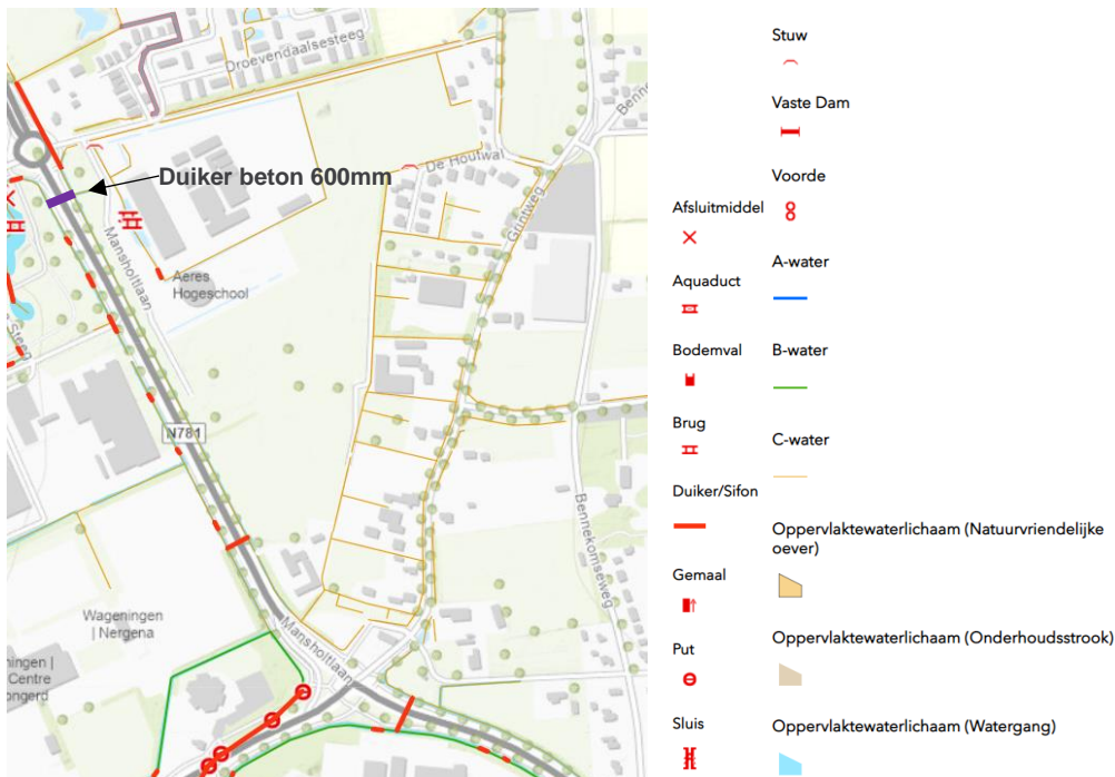
Figuur 2-6 Leggerkaart van waterschap vallei en veluwe geraadpleegd op 17-09-2021. In oranje aanwezige c-watgangen, in het groen de b-watgangen en rood gestreept een duiker. Aanvullende informatie van waterschap Vallei en Veluwe over de wegcruisende duiker onder de Mansholtlaan in het paars toegevoegd.
