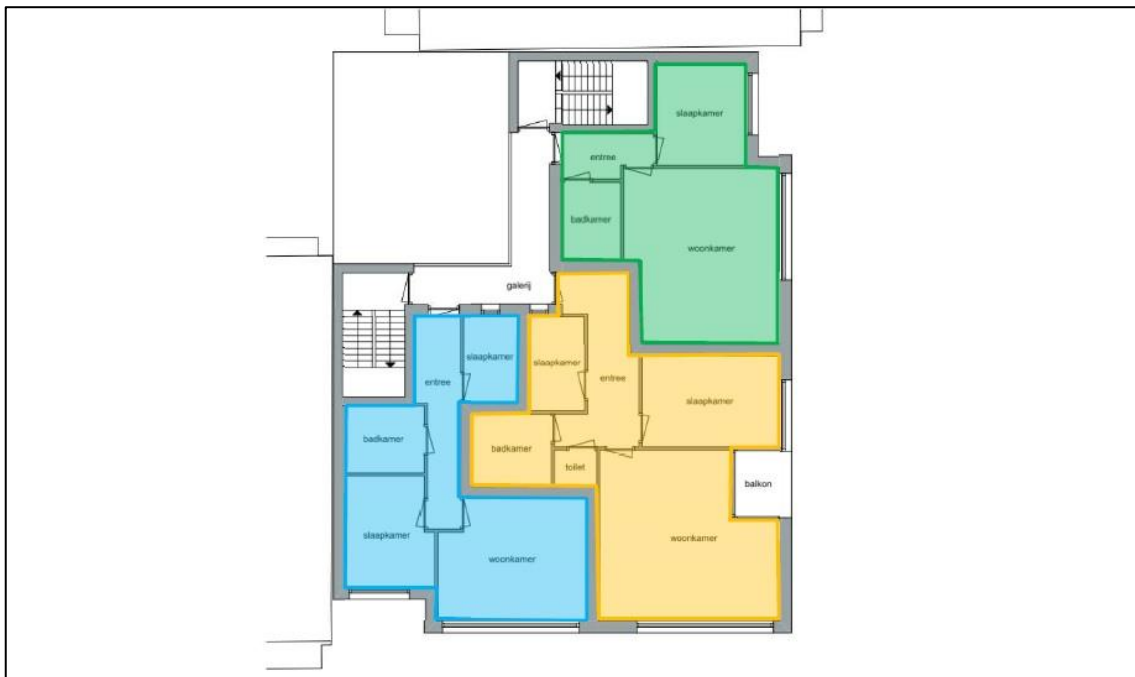
Planopzet indeling bouwlaag met appartementen
