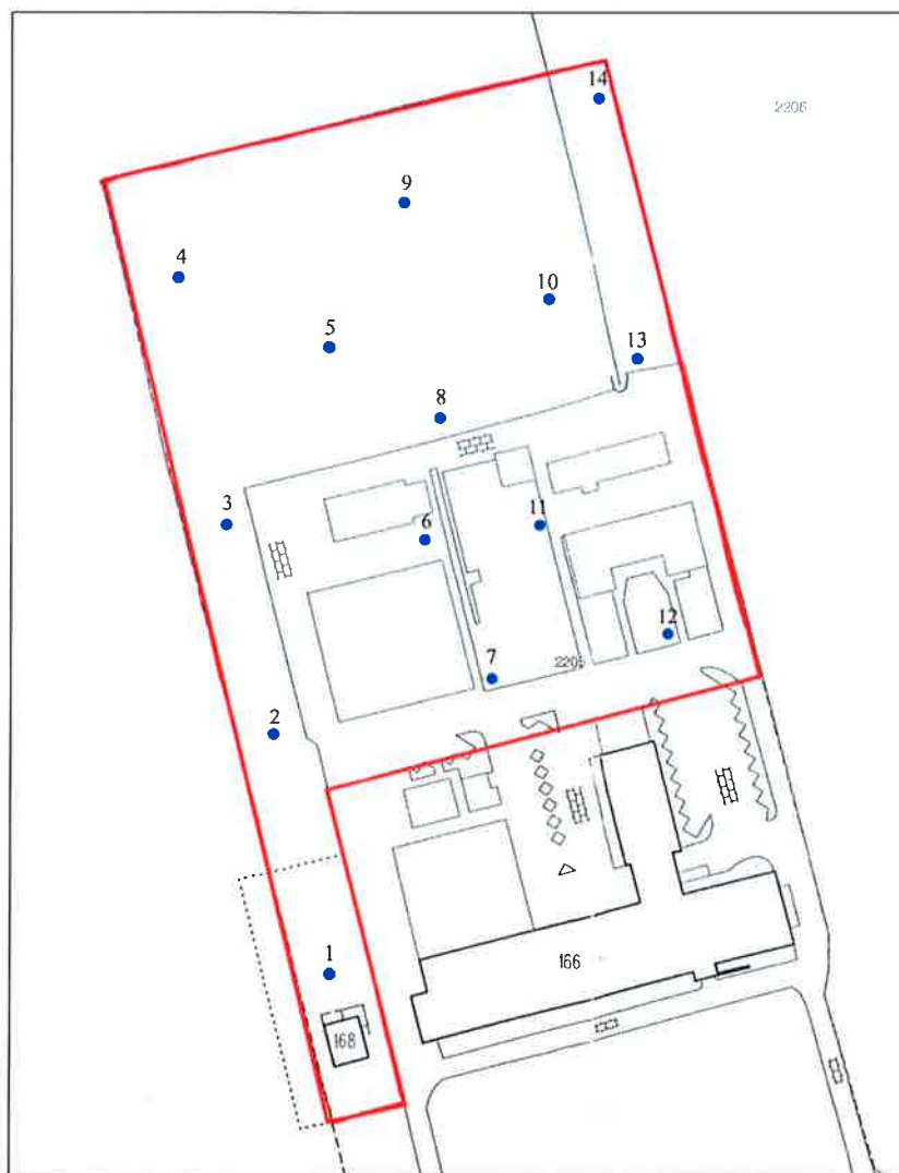
Afbeelding 12. De positie van de boorpunten van het IVO (in blauw), geprojecteerd op een uitsnede van de Kadastrale kaart van het onderzoeksgebied. Het onderzoeksgebied is rood omkaderd. Schaal 1: 1.500.
