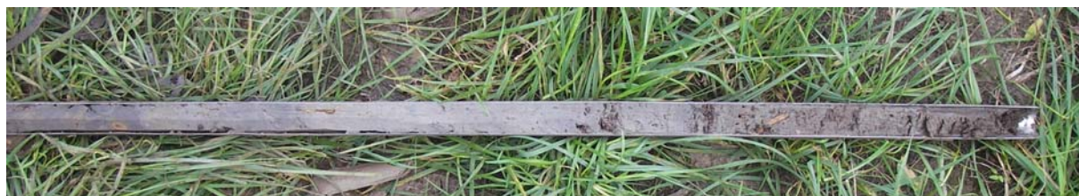
Figuur 3: De venige klei zoals deze onderin boring 8 is aangetroffen met links daarvan de grijze, ongeoxideerde klei.
