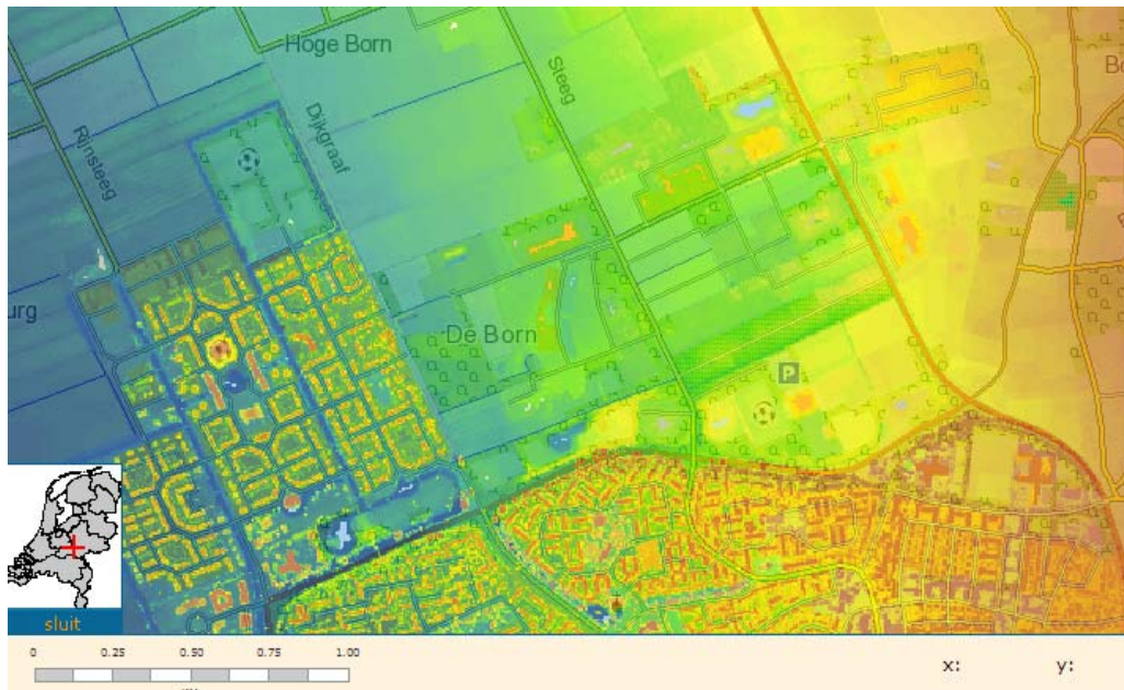
Figuur 2.2 Verskil in hoogteligging plangebied. (AHN. www.ahn.nl ) (van geel naar rood > NAP +11,0 m, van groen naar blauw > NAP +11,0 m en < NAP + 6,50 m)
