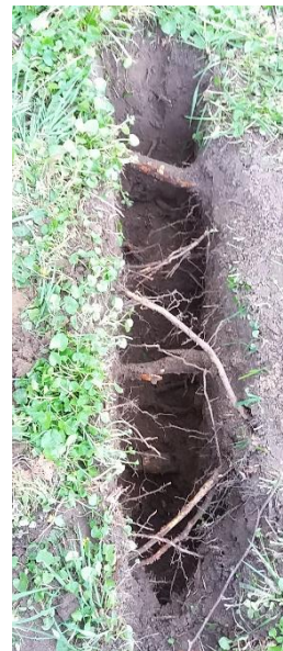
Afb. 40. Oppervlakkige beworteling. Iets minder intensief dan bij boom 14. Exemplaren van 3 cm in de bovenste 20 cm. Een exemplaar van 5 cm doorsnee op 40 cm diepte.
