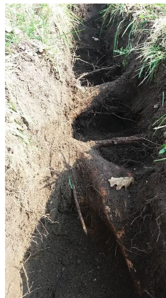
Afb. 36. Bij boom 12 dikke wortels met een diameter van 15 cm op een diepte van 20 cm.
