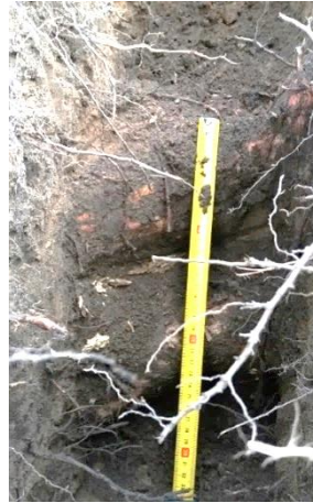
Afb. 28. Proefsleuf bij boom 9 met op 30 cm diepte dikke wortels met een doorsnede van 25 cm.
