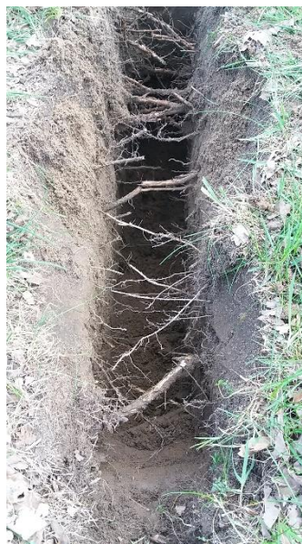
Afb. 34. Bij boom 10 is beworteling aangetroffen in de bovenste 40 cm, tot een diameter van 2 cm.
