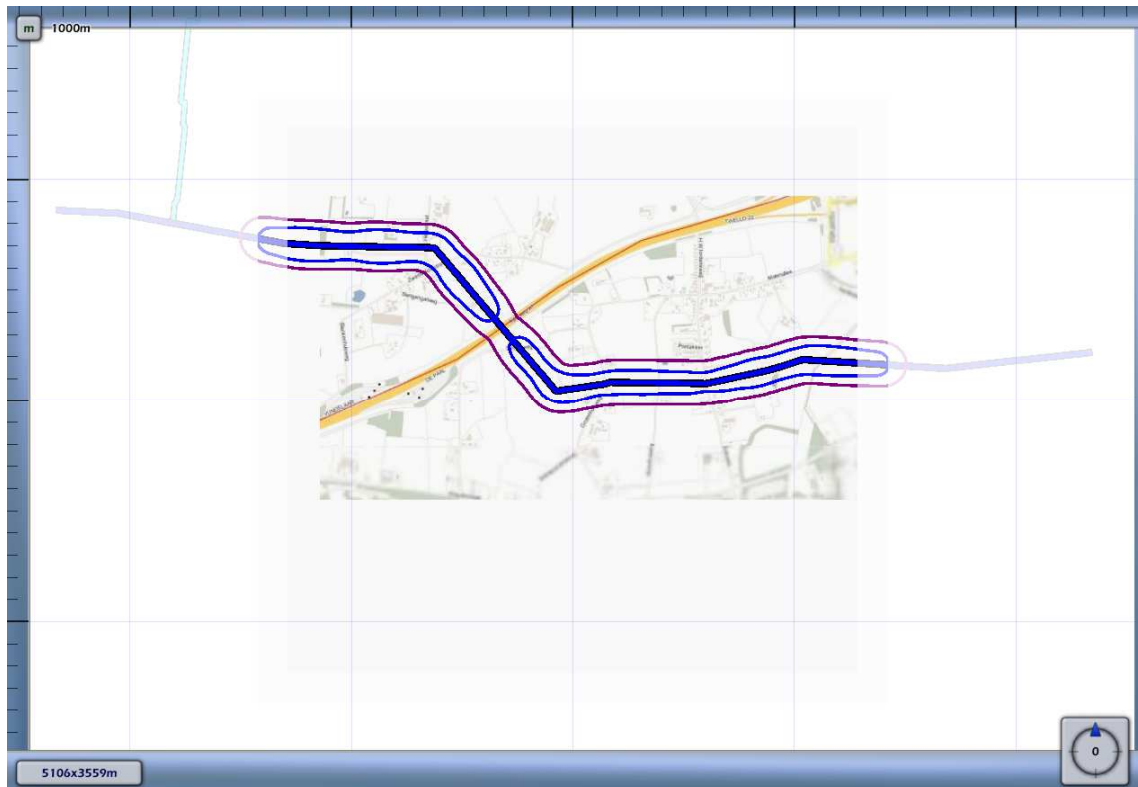
3.1 Figuur 3.1 Plaatsgebonden risico voor N-554-01 van N.V. Nederlandse Gasunie
