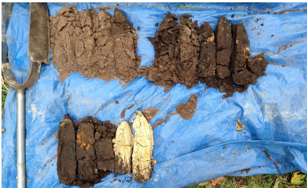
Boring 5: 0-150 cm -Mv. Bovenste rij boorkernen 0-100 cm -Mv, onderste rij boorkernen 100-150 cm -Mv.
