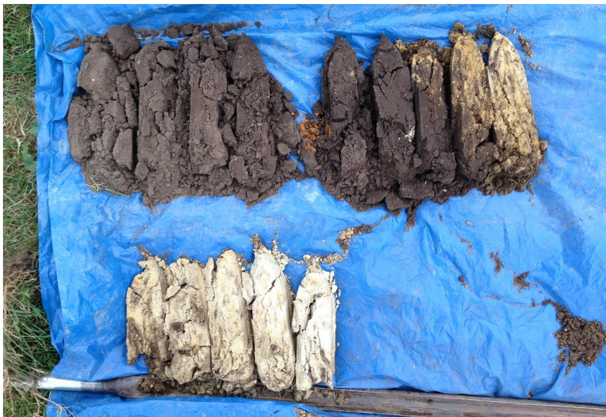
Boring 6: 0-150 cm -Mv. Bovenste rij boorkernen 0-100 cm -Mv, onderste rij boorkernen 100-150 cm -Mv.
