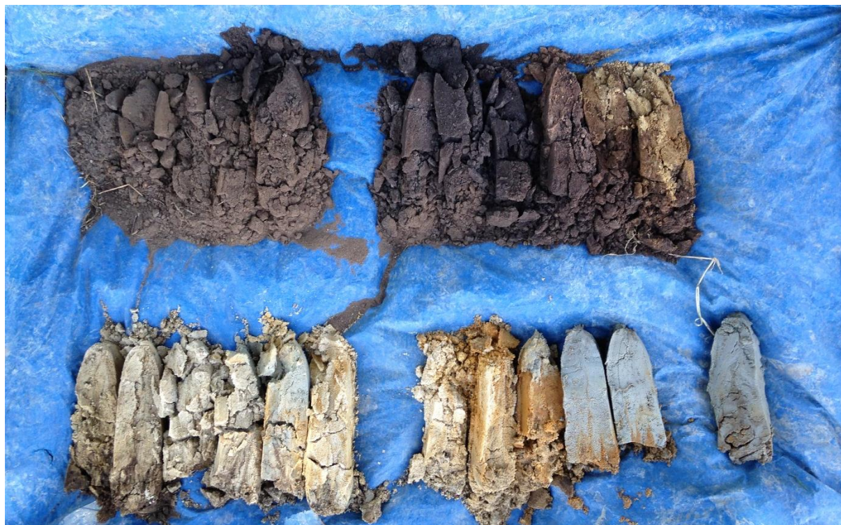
Boring 2: 0-210 cm -Mv. Bovenste rij boorkernen 0-100 cm -Mv, onderste rij boorkernen 100-210 cm -Mv. Bemonsterd van 45-180 -Mv.
