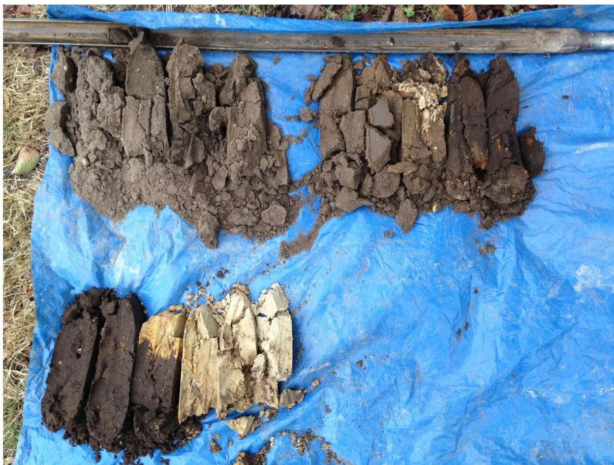
Boring 8: 0-150 cm -Mv. Bovenste rij boorkernen 0-100 cm -Mv, onderste rij boorkernen 100-150 cm -Mv.
