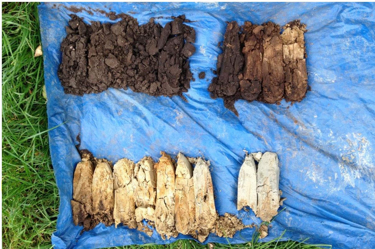
Boring 3: 0-170 cm -Mv. Bovenste rij boorkernen 0-100 cm -Mv, onderste rij boorkernen 100-170 cm -Mv. Bemonsterd van 30-150 cm -Mv.
