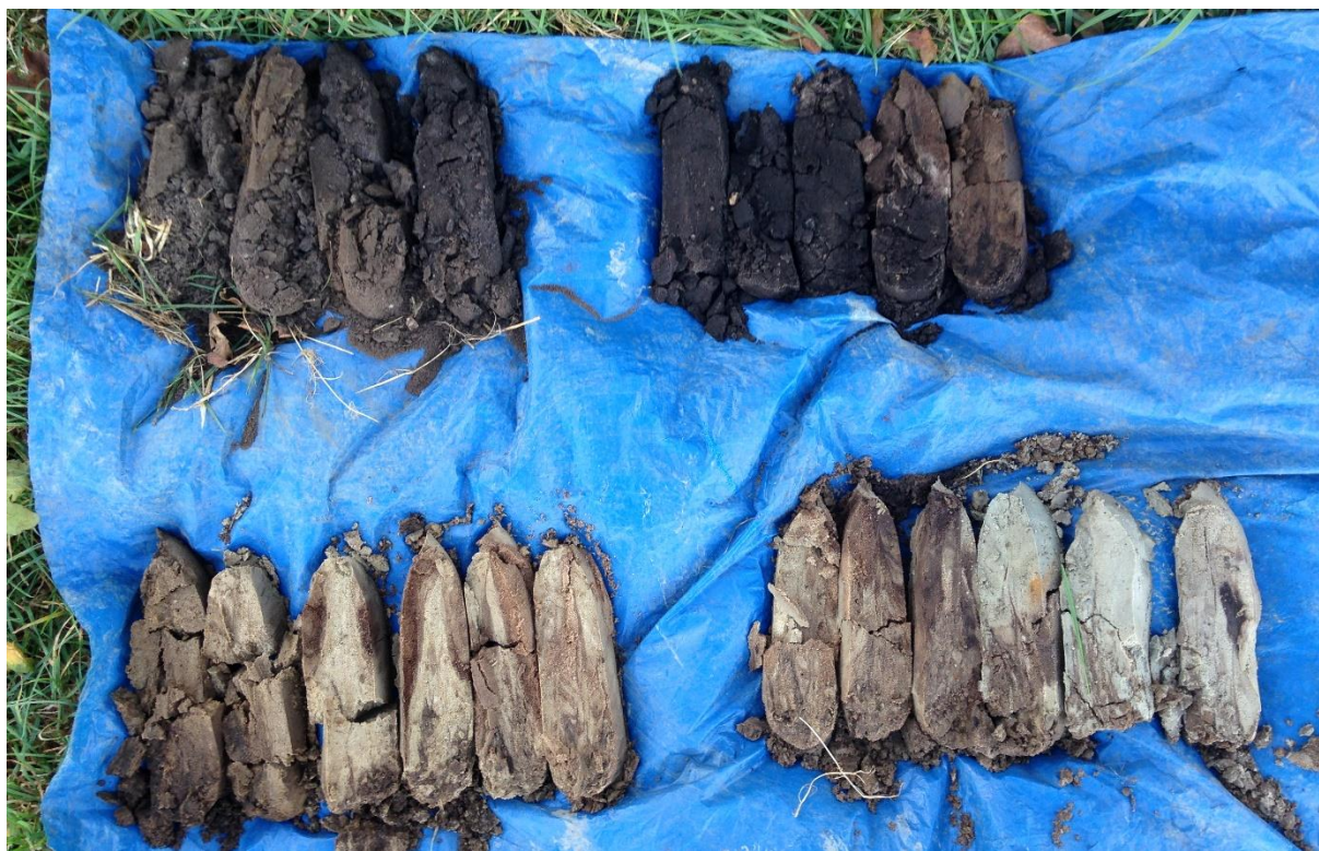
Boring 1: 0-170 cm -Mv. Bovenste rij boorkernen 0-100 cm -Mv., onderste rij boorkernen 100-170 cm -Mv. Bemonsterd van 35-160 cm -Mv.
