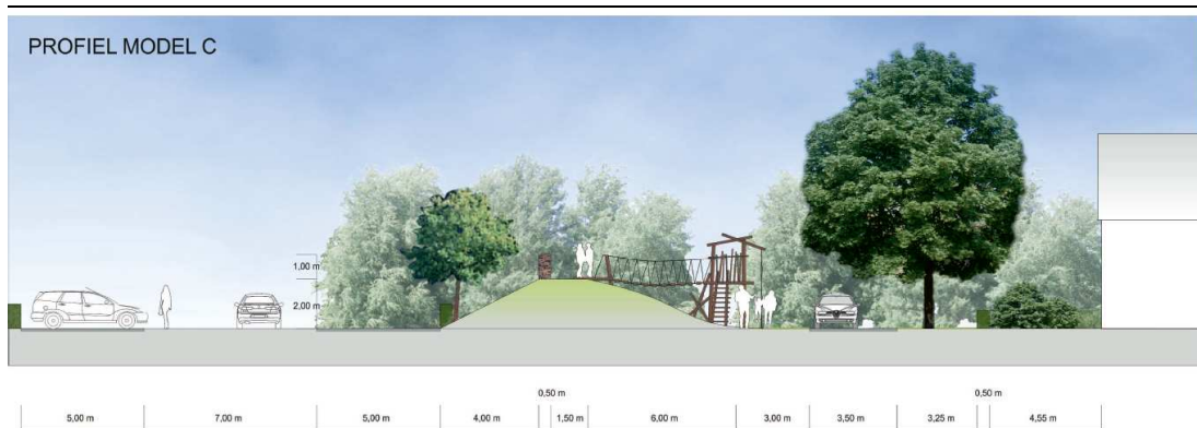
Figuur 2.6 Dwarsdoorsnede overdrachtsmaatregel Dorpszicht model C
