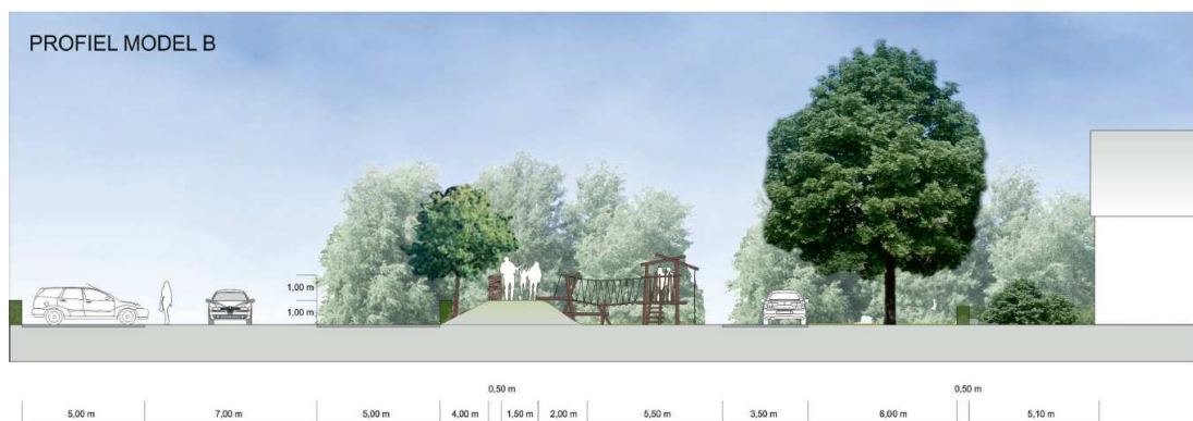
Figuur 2.4 Dwarsdoorsnede overdrachtsmaatregel Dorpszicht model B
