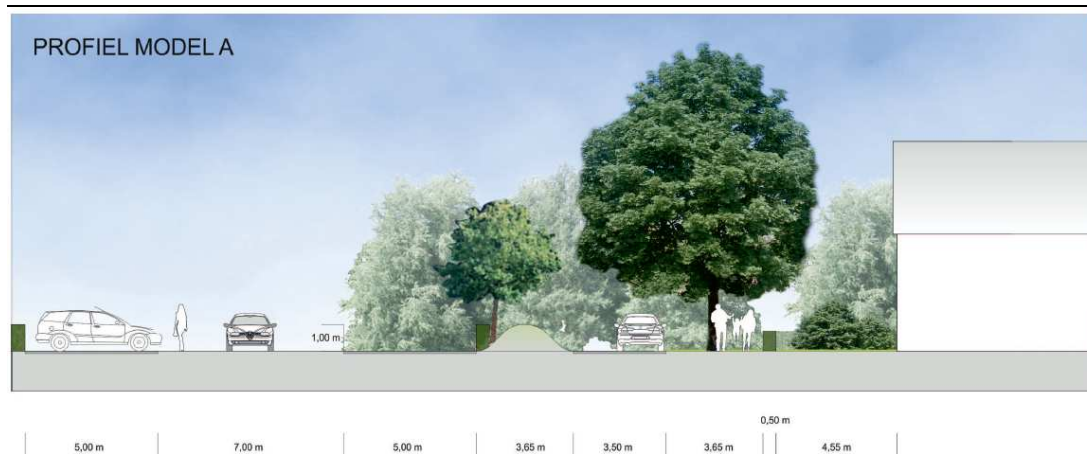
Figuur 2.2 Dwarsdoorsnede overdrachtsmaatregel Dorpszicht model A
