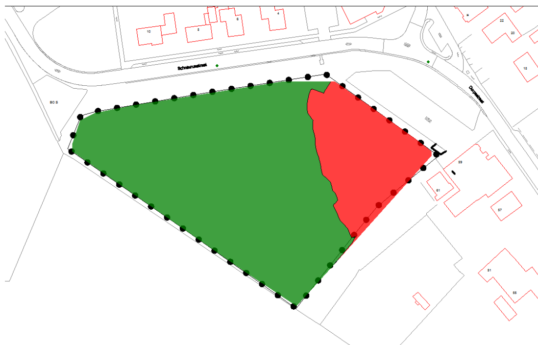
Figuur 4.1 Geluidscontour Kriebelz - 50 dB(A) etmaalwaarde (standaard grenswaarde, inclusief 10 dB muziektoeslag) ligt op maximaal circa 70 meter planinwaarts. In het rode vlak ligt de geluidsbelasting boven de 50 dB(A) etmaalwaarde en is geluidshinder aanmerkelijk
