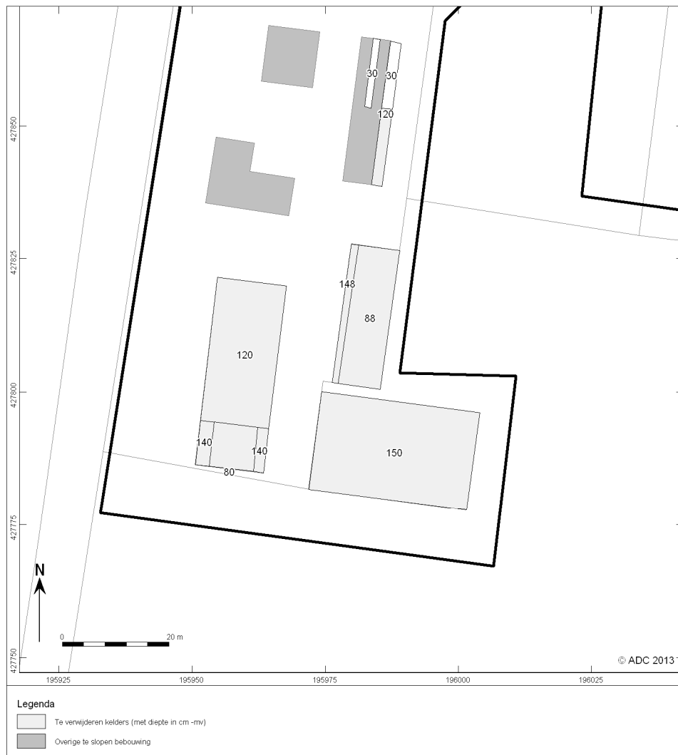
Afb. 3 Te slopen kelders
