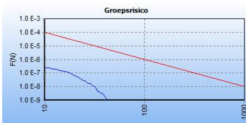
Figuur 2.7: fN-curve buisleiding W-525-01-deel-1 ná planrealisatie
