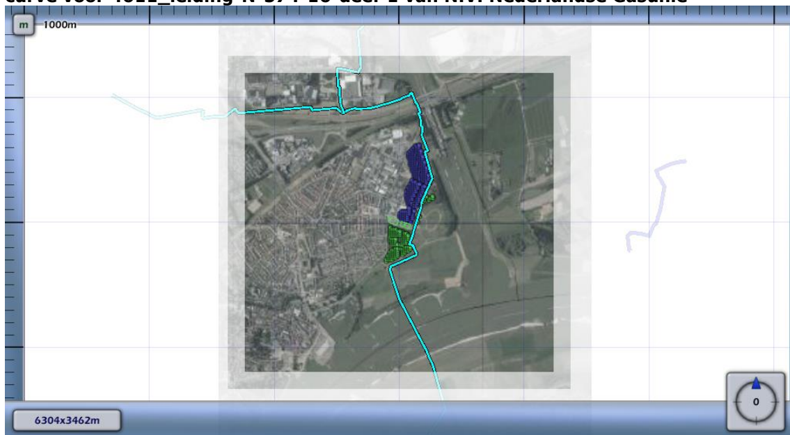
Figuur 4.2 Kilometer leiding behorende bij de maximale overschrijding van de FN-curve voor 4611_leiding-N-574-16-deel-1 van N.V. Nederlandse Gasunie
