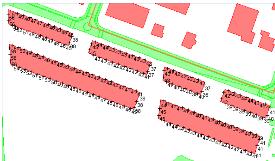
Figuur 8 Hoogst berekende gecumuleerde geluidbelasting (exclusief aftrek artikel 110g Wgh)
