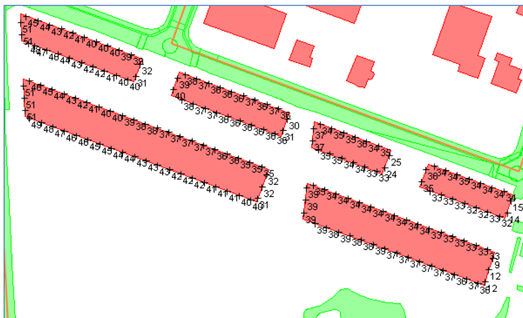
Figuur 7 Hoogst berekende gecumuleerde geluidbelasting vanwege de 30 km/uur wegen inclusief aftrek conform artikel 110g Wgh
