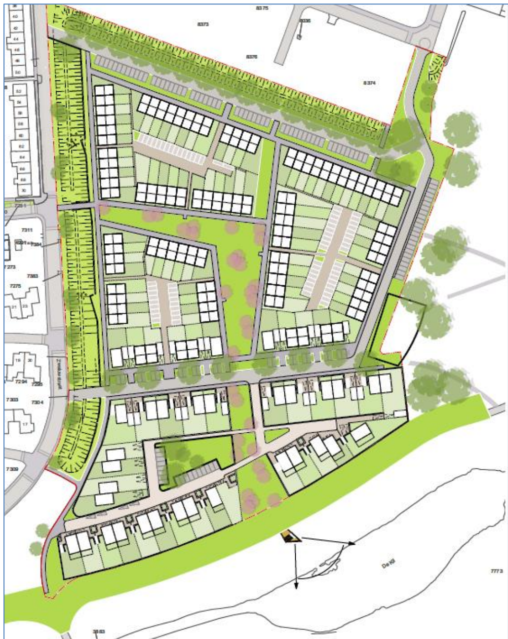
Conceptverkevelingsplan van het plangebied. De groenstroken aan de noord- en westzijde fungeren tevens als wadi. Bron Imoss, conceptverkevelingsplan augustus 2016.
