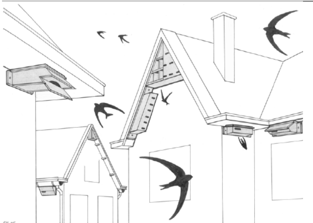
Figuur 3.5 Voorbeelden van houten nestkasten voor de Gierzwaluw en locaties waar deze geplaatst kunnen worden [© Gierzwaluwbescherming – Nederland].
