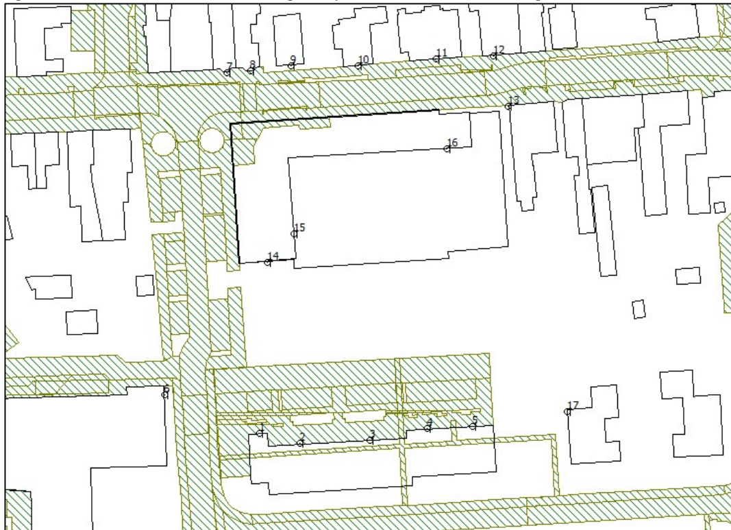
Figuur 4.3: overzicht en nummering toetspunten rekenmodel inrichtingslawaai
