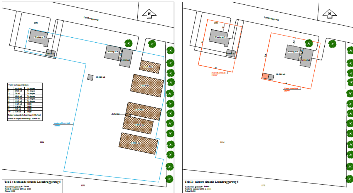
Afbeelding 3.3: Links: overzicht van de te slopen opstallen (rood gearceerd) en het bestaande bouwblok (blauw weergegeven). Rechts: Toekomstige inrichting van het plangebied, met de nieuwe bouwblokken (rood weergegeven). Bron: Graveland Bouwontwerp, 2017.
