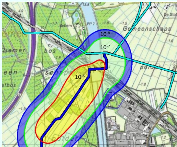
Figuur 2.1 plaatsgebonden risicocontouren
