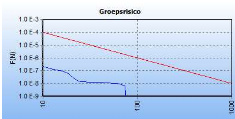
Figuur 5.1 FN curve voor 4538_leiding-N-570-26-deel-1 van N.V. Nederlandse Gasunie voor de kilometer tussen stationing 2170.00 en stationing 3170.00
