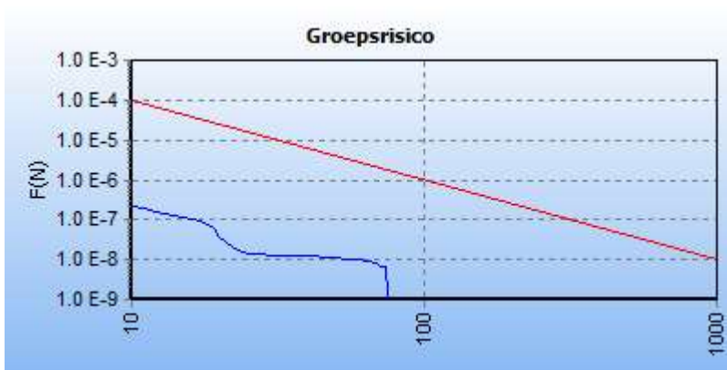
Figuur 5.1 FN curve voor 4538_leiding-N-570-26-deel-1 van N.V. Nederlandse Gasunie voor de kilometer tussen stationing 2170.00 en stationing 3170.00
