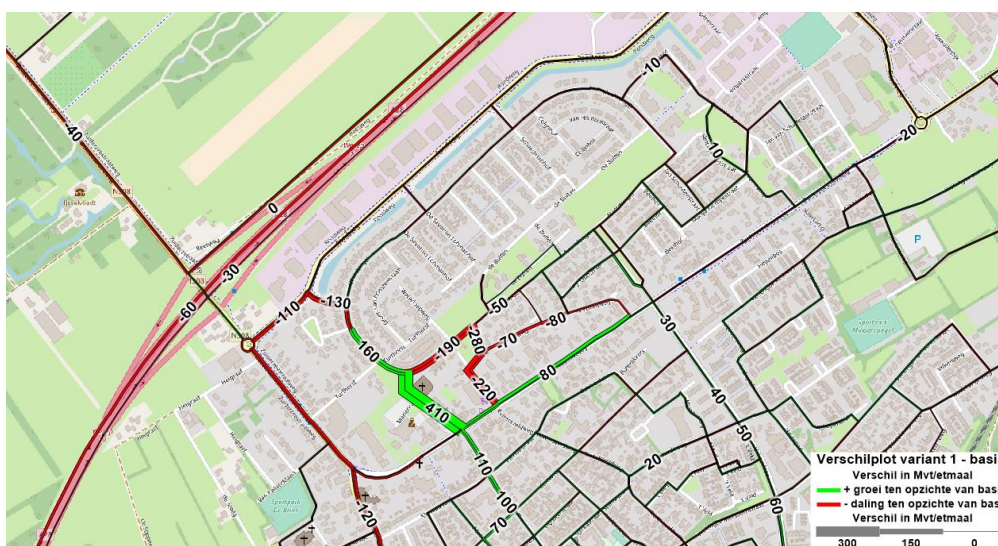
Figuur 2: Verschil etmaalintensiteiten tussen Variant 1 en basissituatie 2030
