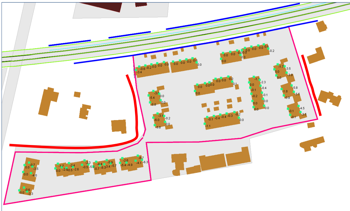
Figuur 7: Verlengd geluidscherm +3,7 mmv, waarneemhoogte 7,5 m. (Var. 2)
