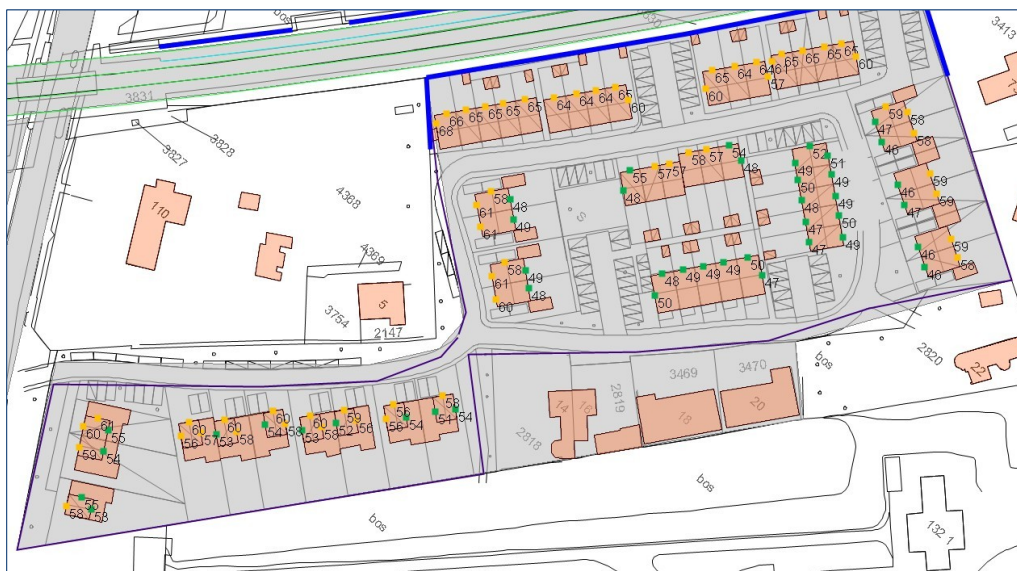
Figuur 4: resultaten met scherm 3,7 mmv, waarneemhoogte 4,5 m.
