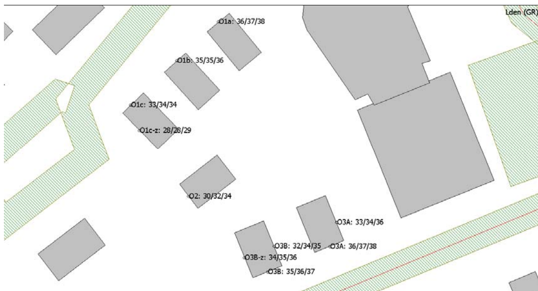
Figuur 5.6 Geluidbelasting Veluwelaan op gevels van variant 1
