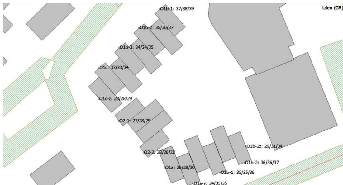
Figuur 5.10 Geluidbelasting Veluwelaan op gevels van variant 2
